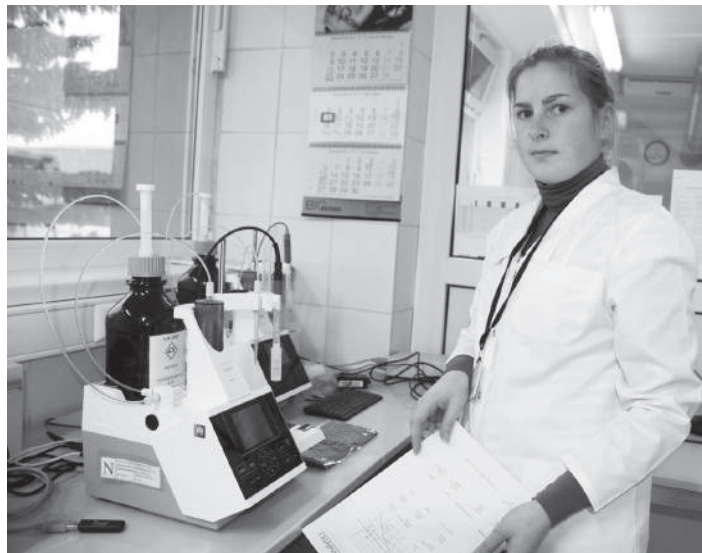
UAB „Nepriklausoma tyrimų laboratorija“ l.e.p. inžinierė chemikė-techninė vadovė Rasa Ilkskytė prie automatinio programuojamo titratoriaus pieno produktų kokybei tirti su programine įranga.
